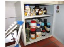
Bild 10: Lagerung brennbarer Flüssigkeiten in speziellen Sicherheitsbehältern
